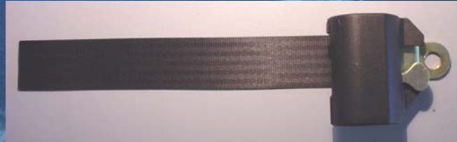
Cintura di sicurezza con arrotolatore a blocco comandato
